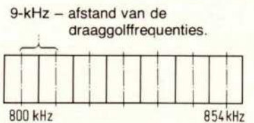
Fig. 10 De afstand tussen twee zenders in het middengolfbereik bedraagt 9 kHz.
