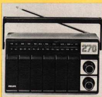
De AM/FM portable 90 AL 270 met een uitgangsvermogen van 800 mW.
