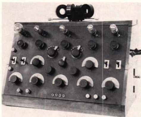
Afb. 8. Ontvanger fabriikaat Idzerda, met 21 bedieningsknoppen (1923).
